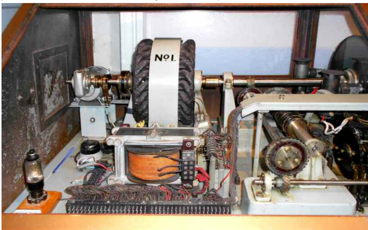
Obr. 8 - Synchronní motor, který poháněl baterii kotoučů se záznamy časových údajů (Obrázek se svolením Britského horologického institutu).
