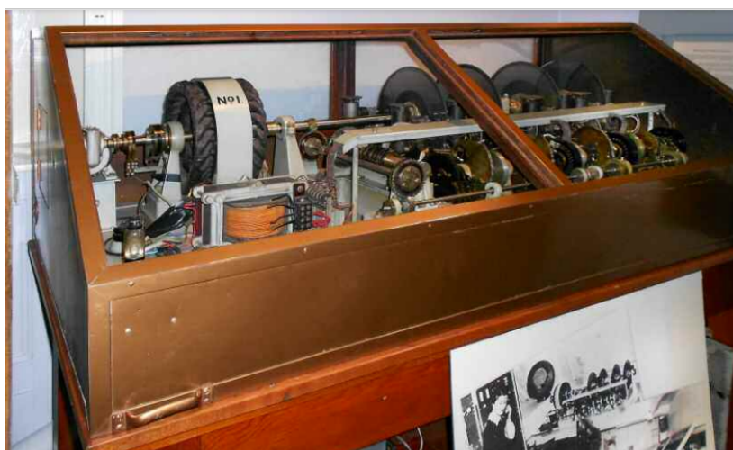
Obr. 8 - Synchronní motor, který poháněl baterii kotoučů se záznamy časových údajů (Obrázek se svolením Britského horologického institutu).
