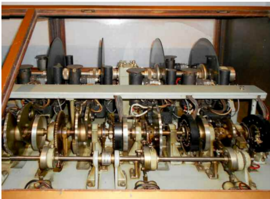
Obr. 10 - Skříň s hodinami a synchronizační elektronikou mluvicích hodin č. 2 Britské pošty
