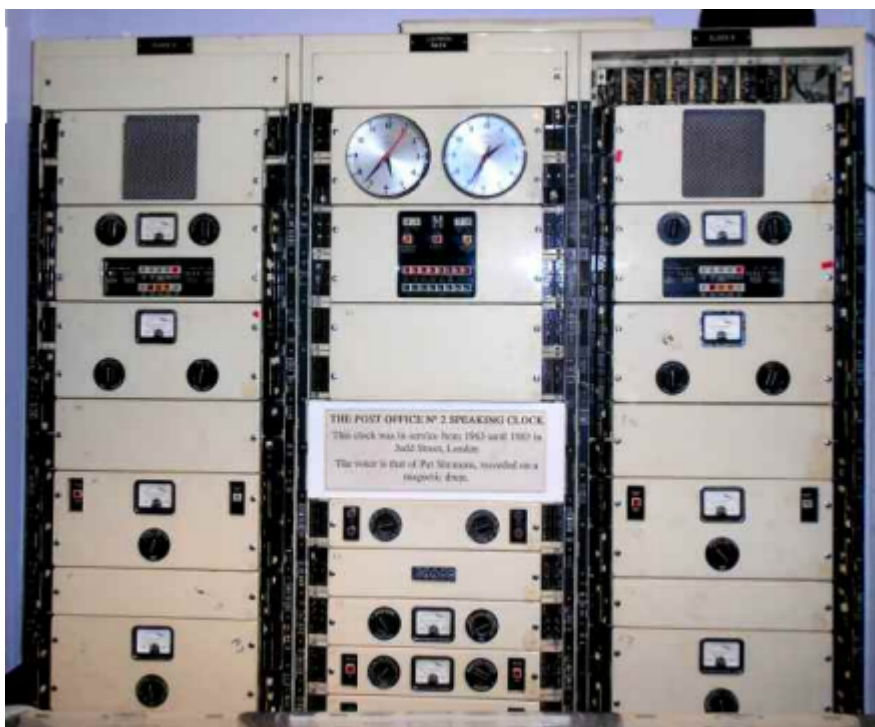
Obr. 10 - Skříň s hodinami a synchronizační elektronikou mluvicích hodin č. 2 Britské pošty
