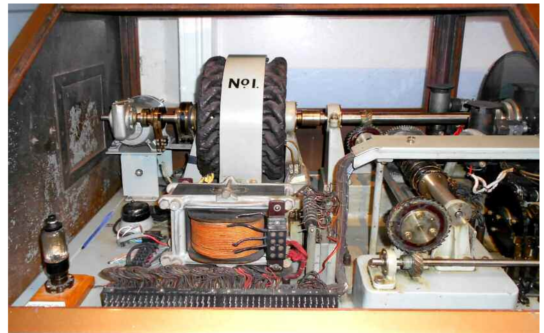
Fig. 8 - Il motore sincrono che azionava la batteria di dischi contenenti le registrazioni delle indicazioni orarie (Immagine cortesemente concessa dal British Horological Institute).
