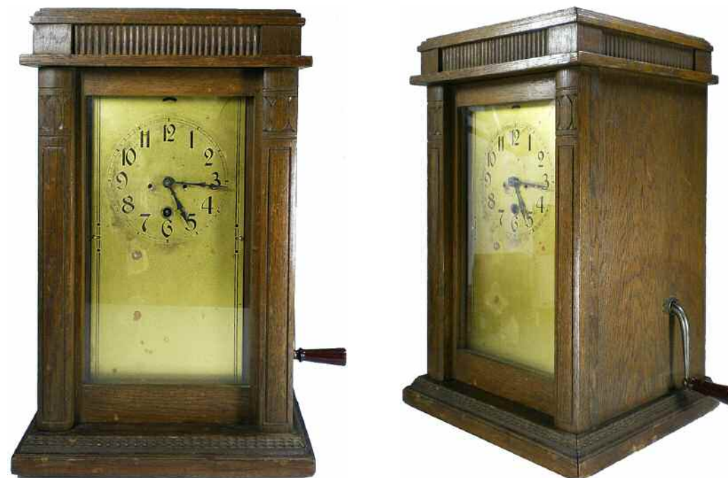
Fig. 3a, b - L'orologio parlante di Hiller: basato sul principio del fonografo, utilizzava come supporto per l'incisione del parlato un nastro di celluloido impregnato di canfora.
