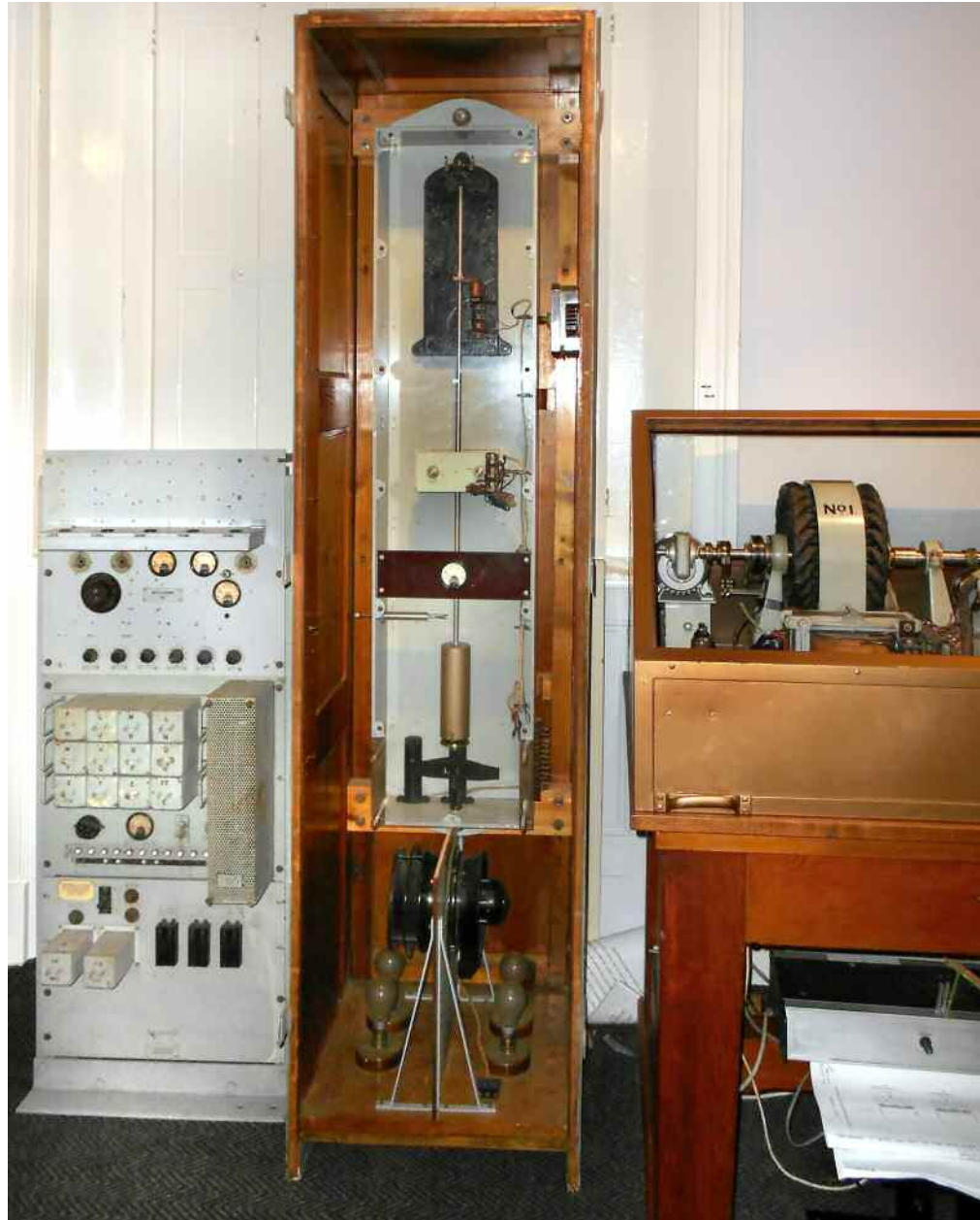
Fig. 6 - L'orologio parlante N. 1 del Post Office britannico: l'orologio campione era posto nella colonna centrale, a destra si intravede il sistema di riproduzione sincronizzata. (Immagine cortesemente concessa dal British Horological Institute)
