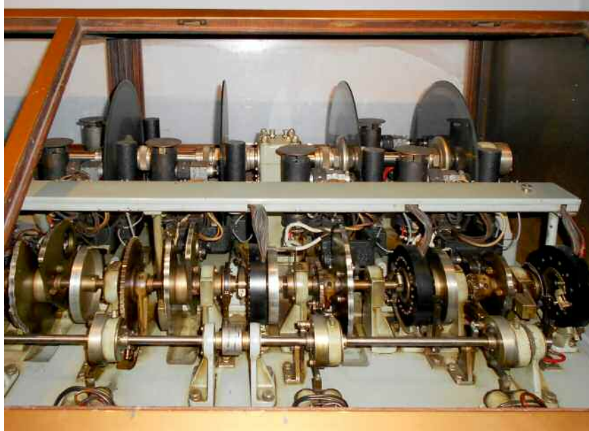
Fig. 9 - I quattro dischi su cui erano incise le registrazioni delle indicazioni di ore e minuti (Immagine cortesemente concessa dal British Horological Institute).
